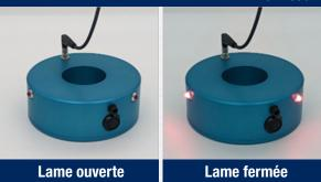
L'interrupteur étanche installé dans la poche de l'outil s'enforce lorsque la lame se referme contre lui. Cela envoi un signal électronique à l'anneau lumineux LED situé sur le côté « spindle » de l'outil pour informer l'opérateur de la machine que la lame est complètement fermée à l'arrière de la pièce.
