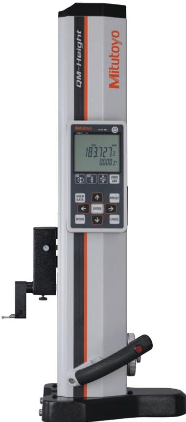
La série QM-Height est une jauge de hauteur de haute performance, avec la meilleure précision de sa catégorie  $\pm (2,4 + 2,1 L / 600) \mu\text{m}$ , avec l'option pneumatique intégrée pour un glissement sans friction avec un panneau de contrôle simple facile à visualiser. Cliquez sur le bouton Afficher les informations sur le produit ci-dessous pour en savoir plus sur toutes les spécifications de l'appareil. En ce moment pour une durée limitée, 20% de réduction!
