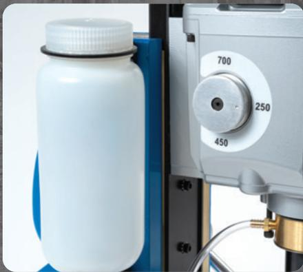
Trois vitesses permettent l'utilisation à la fois des fraises annulaires « série 12 000 » et les fraises annulaires au carbure Copperhead. Le bon RPM offre la meilleure durée de vie de l'outil
