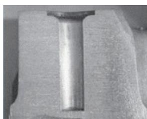
Les réglages de position approximatifs et la nature inclinée des trous moulés peuvent entraîner un décalage de position dans les opérations suivantes...
